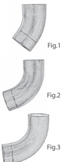
Elemento di raccordo che permette una variazione di direzione prodotto da tubo elettrosaldato.
